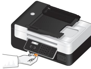
Brug den orange tape til at løfte betjeningspanelet, indtil det *klikker* på plads. Fjern tapen, og smid den derefter ud.
