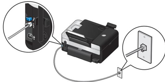
Hvis du vil sende og modtage faxer, skal du slutte en aktiv telefonlinje til FAX-porten (F). Hvis du bruger et DSL-modem til computeren, skal du installere et DSL-filter. Kontakt DSL-udbyderen for at få hjælp.
