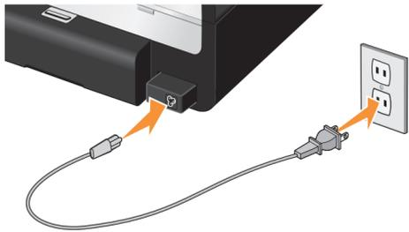
Sæt netledningen i strømforsyningen bag på printeren og i en stikkontakt på væggen.
