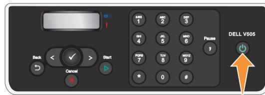
Tryk på **tænd/sluk**-knappen på betjeningspanelet for at tænde printeren. Kytte tulostimeen virta painamalla käyttöpaneelin **virtanäppäintä**.
